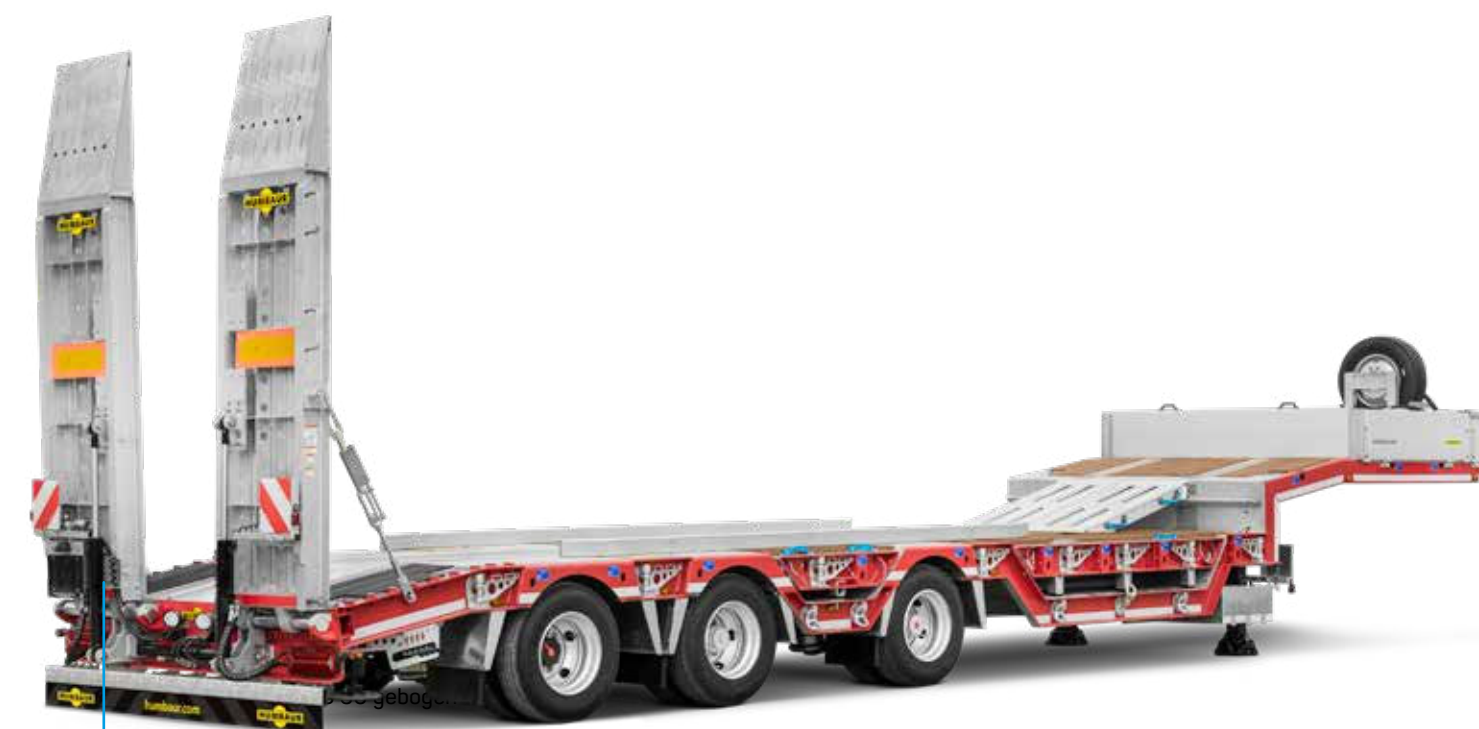
De uniek vlakke oprijhoek van 10° maakt het uitrijden over de oprijplaat van 3,15 m eenvoudig en veilig.
