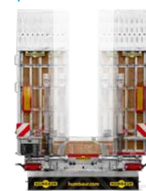
Verschillende oprijbreedtes zijn direct mechanisch of optioneel hydraulisch in te stellen
