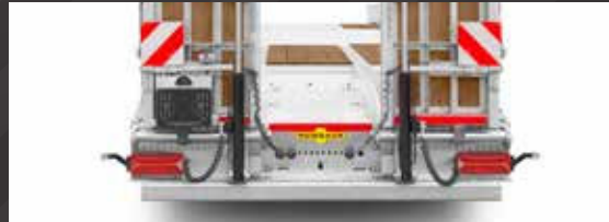
Oprijplaat uit een deel met hydraulische oprijplaatlift
