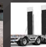
Rubberen vloerbedekking op aluminium panelen voor oprijplaten
