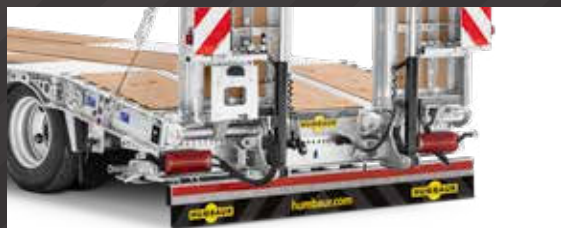
Oprijplaat uit een deel met hydraulische oprijplaatlift
