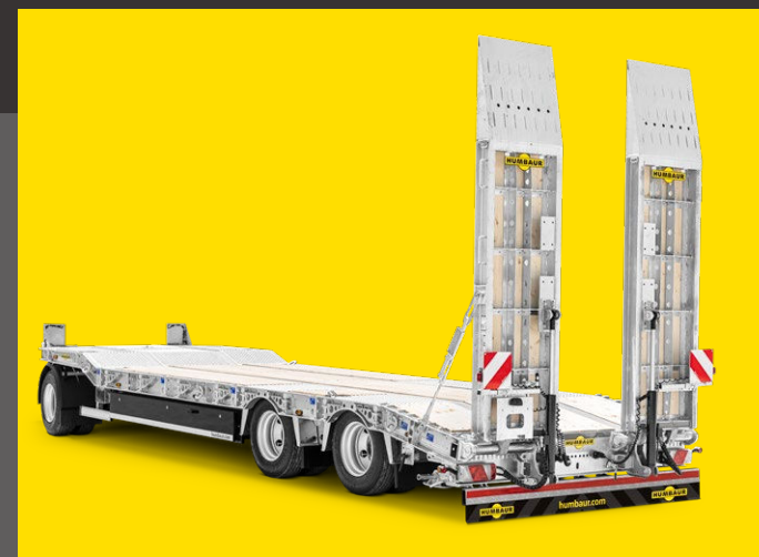
Rubber vloerbedekking op aluminium panelen voor hellingen
