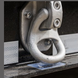
Geïntegreerd in het buitenframe geïntegreerd vastzetpunt tot 6 000 kg trekkracht
