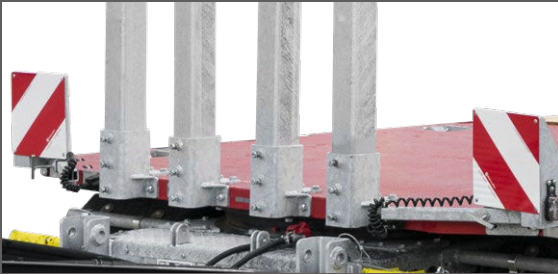
Stanchion pocket en insteeksteunen bevestigd aan de voorkant, waarschuwingsplaten
