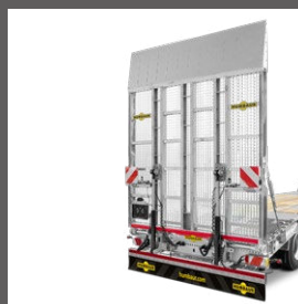
Stalen schanswand over de over de gehele breedte met Rooster
