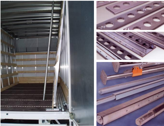
▲ Vloer en dak met gatenprofiel voor verankering ladingstangen
