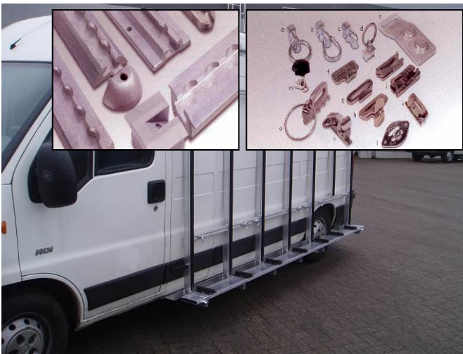
▲ Verankering met ringen in vliegtuigrail
