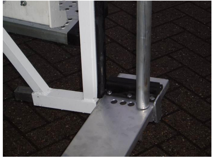
▲ Gaten in opzetplank voor ladingstang + rubberen strips
