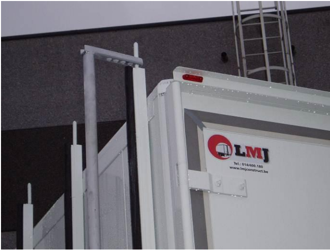
▲ Vergrendelingsprofielen voor het gebruik van ladingstangen met dakpen vergrendeling
